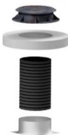
Compléter l'installation en ajustant la hauteur des cheminées d'accès puis en y superposant les anneaux de support et les cadres et couvercles en fonte. **La dalle de répartition de charge en béton ainsi que le cadre de fonte ne doivent d'aucune façon s'appuyer directement sur la cheminée, de manière à éviter des charges ponctuelles sur la structure.**
